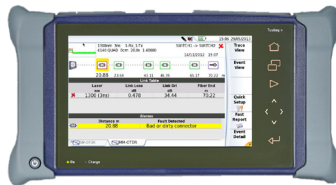
单模/多模光纤测试和企业 IT 网络测试的双槽位手持式模块化平台
