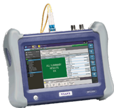
用于测试 10/100G 以太网和光纤网络的 MTS-5800 手持式测试仪表
