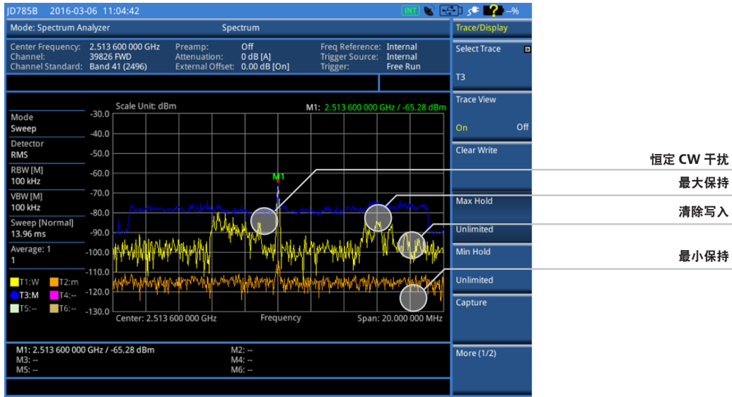
图 5. 频谱分析仪模式下的 LTE-TDD 信号（显示不同轨线模式）
