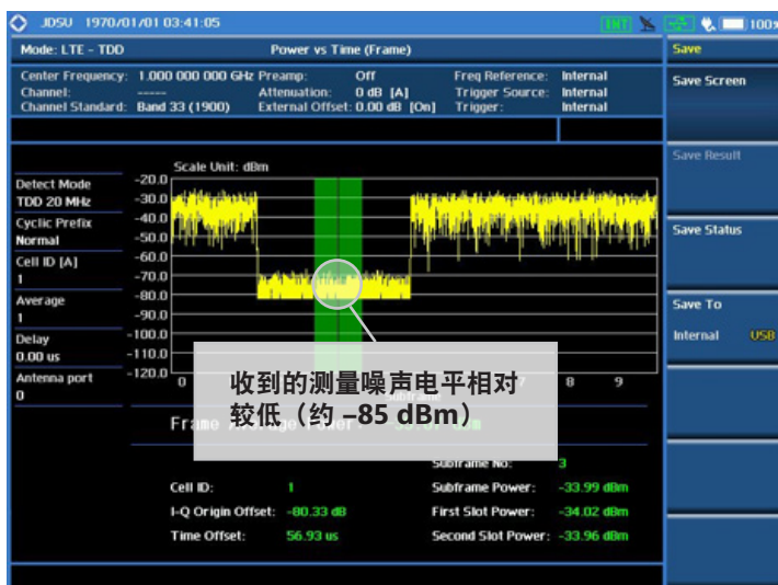
图 21a. LTE-TDD 信号的“功率与时间（帧）”图
