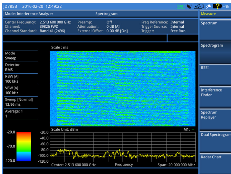
图 13. 20 MHz LTE-TDD 信号的频谱瀑布图视图，无干扰（非选通）
