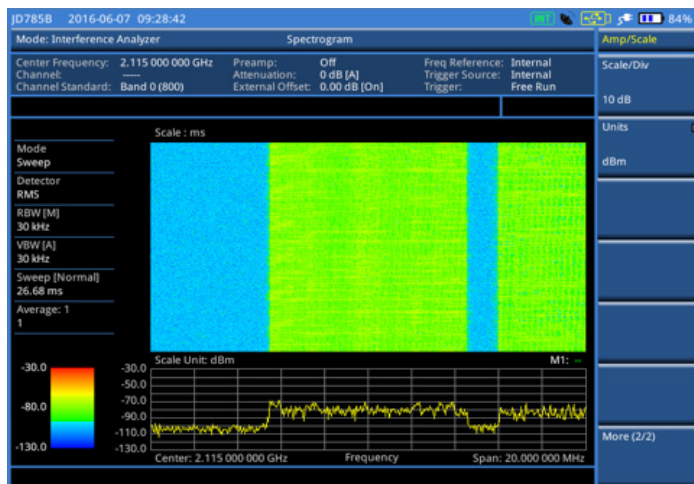
图 15a. 标尺/分度设置为 10 dB/分度的频谱瀑布图视图
