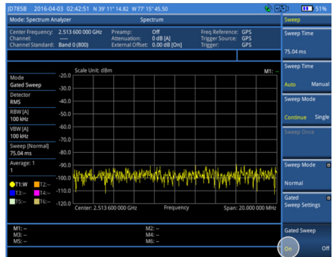
图 11b. 门控扫描设置为打开时的 LTE-TDD 频谱
