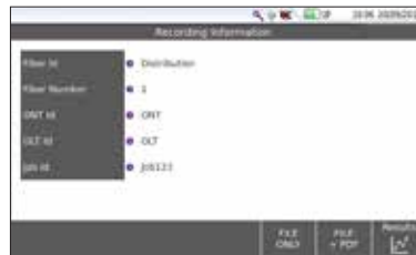
4 使用 PON 标准命名约定 (.sor 和/或 .pdf 格式) 记录测试结果
