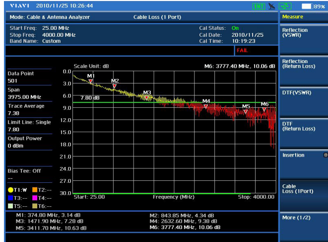
电缆和天线测试 - 电缆损耗
