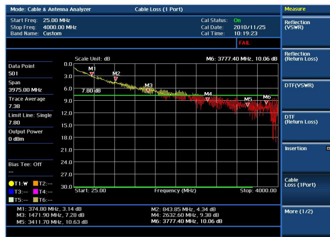
电缆和天线测试 - 电缆损耗
