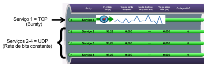
Figura 19. Fase de teste de desempenho Y.1564 com serviço TrueSpeed integrado
