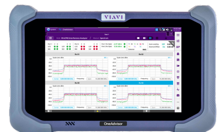
Análise de interferência de RFoCPRI do OneAdvisor
