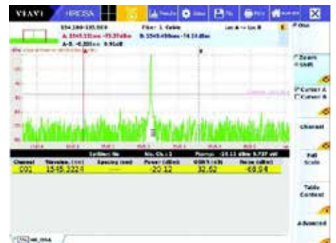
波長計 GUI 表示(波長、パワー、簡易スペクトラム)
