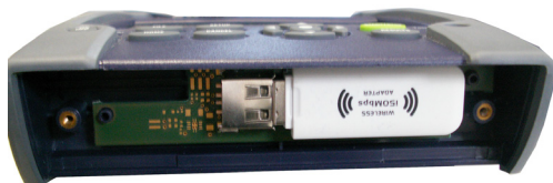
Figure 41 USB WIFI installé dans la Plate-forme
