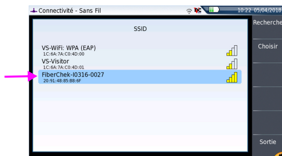
Figure 23 Microscope FiberChek détecté en WIFI
