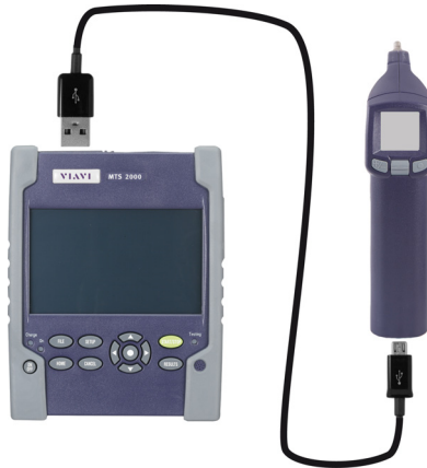
Figure 24 Connexion WIFI du microscope FiberChek à la Plate-forme SmartOTDR
