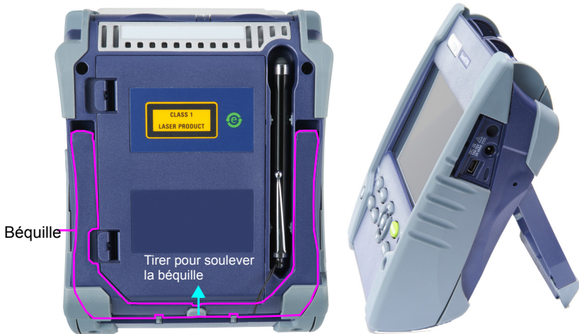
Figure 7 Plate-forme en position «utilisateur assis» et «utilisateur debout»
