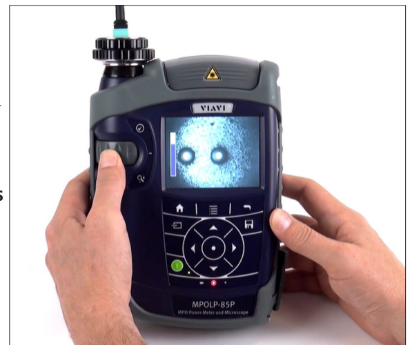
Inspection des connecteurs MPO avec le PCM intégré
