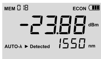
Figure 5 Affichage en mode Auto- \lambda illustrant une longueur d'onde détectée ainsi que son niveau.
