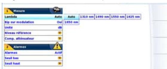
Figure 234 Configuration de la mesure de puissance
