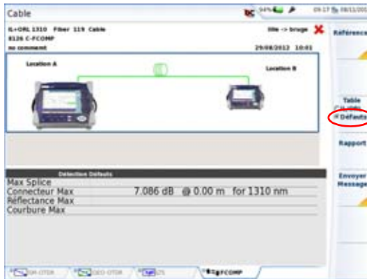
Figure 124 Écran de résultats Détection Défauts
