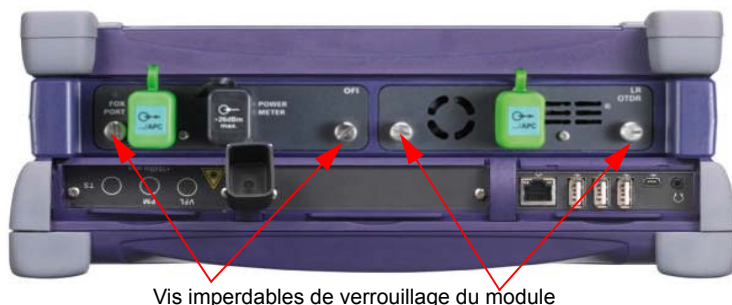
Figure 7 Vue arrière du MTS 8000
