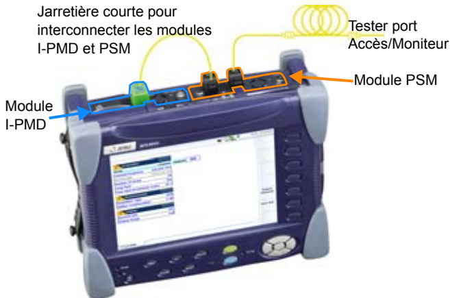
Figure 157 Interconnexions des modules
