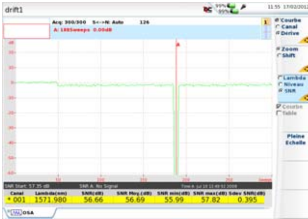
Figure 139 Exemple de mesure de dérive
