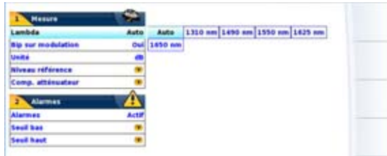
Figure 94 Configuration de la mesure de puissance
