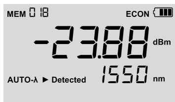
Fig. 5 Visualización en modo Auto- \lambda que muestra una longitud de onda registrada con su potencia
