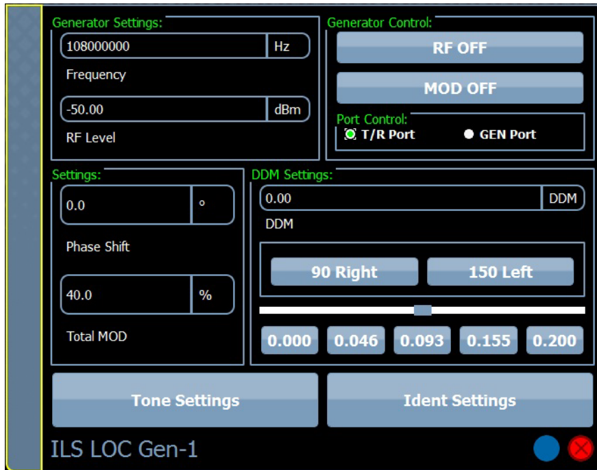
Fig. 2-16 ILS - LOCALizer generator GUI
