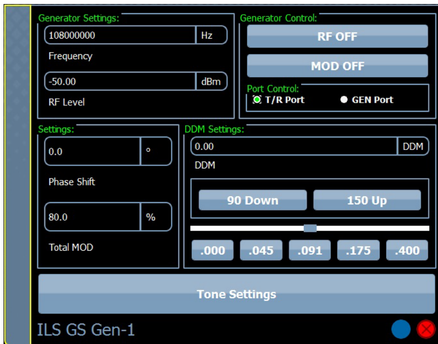
Fig. 2-17 ILS GlideSlope generator GUI
